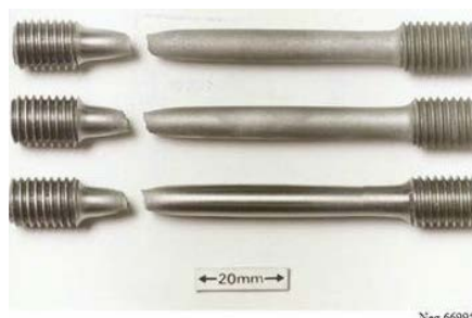
รูปการทดสอบการเสียรูปของโลหะ
